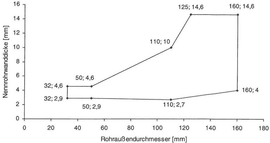
**Bild 14: Rohre gemäß Rohrgruppe C (PP):** Einbau in Massivwände;  $d_w \geq 100$  mm; Feuerwiderstandsklasse EI 120-U/C
