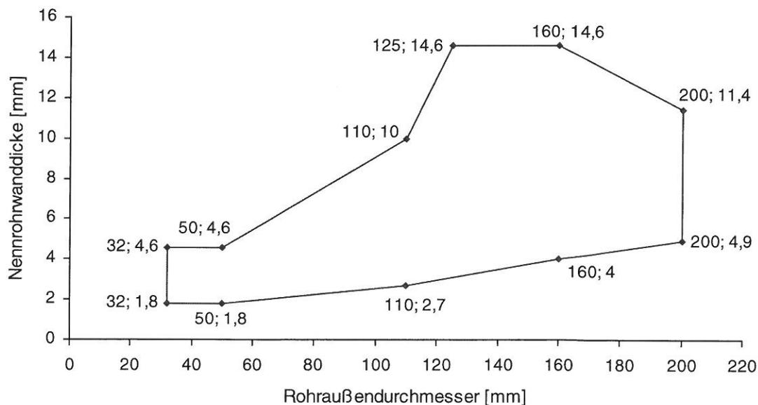
**Bild 16: Rohre gemäß Rohrgruppe C (PP):** Einbau in Massivdecken;  $d_D \geq 300$  mm; Feuerwiderstandsklasse EI 120-U/C
