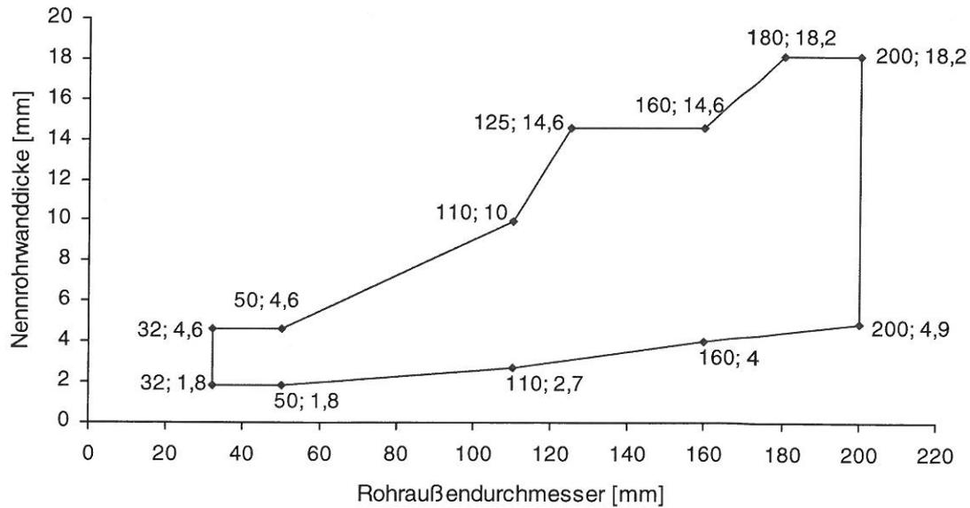
**Bild 12: Rohre gemäß Rohrgruppe B (PE-HD):** Einbau in Massivdecken;  $d_D \geq 300$  mm;
