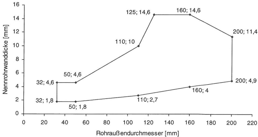
**Bild 10: Rohre gemäß Rohrgruppe B (PE-HD):** Einbau in Massivwände;  $d_w \geq 300$  mm;
