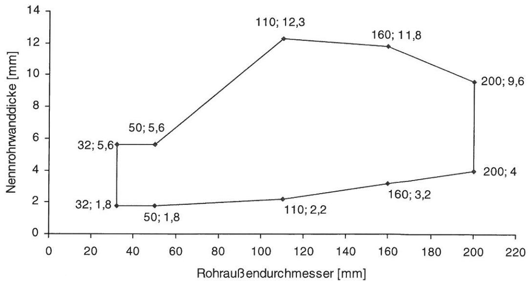
**Bild 4: Rohre gemäß Rohrgruppe A (PVC):** Einbau in Massivwände;  $d_w \geq 100$  mm; Feuerwiderstandsklasse EI 240-U/C
