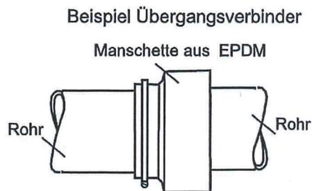
Feuerwiderstandsfähige Abschottung für Rohrleitungen aus Metall mit Anschluss von Rohren aus Kunststoff "System Vario-Sol, Variante 1"
