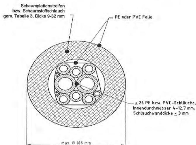
Feuerwiderstandsfähige Abschottung für Rohrleitungen aus Kunststoff "Armaprotect, Typ Armaprotect PP"
