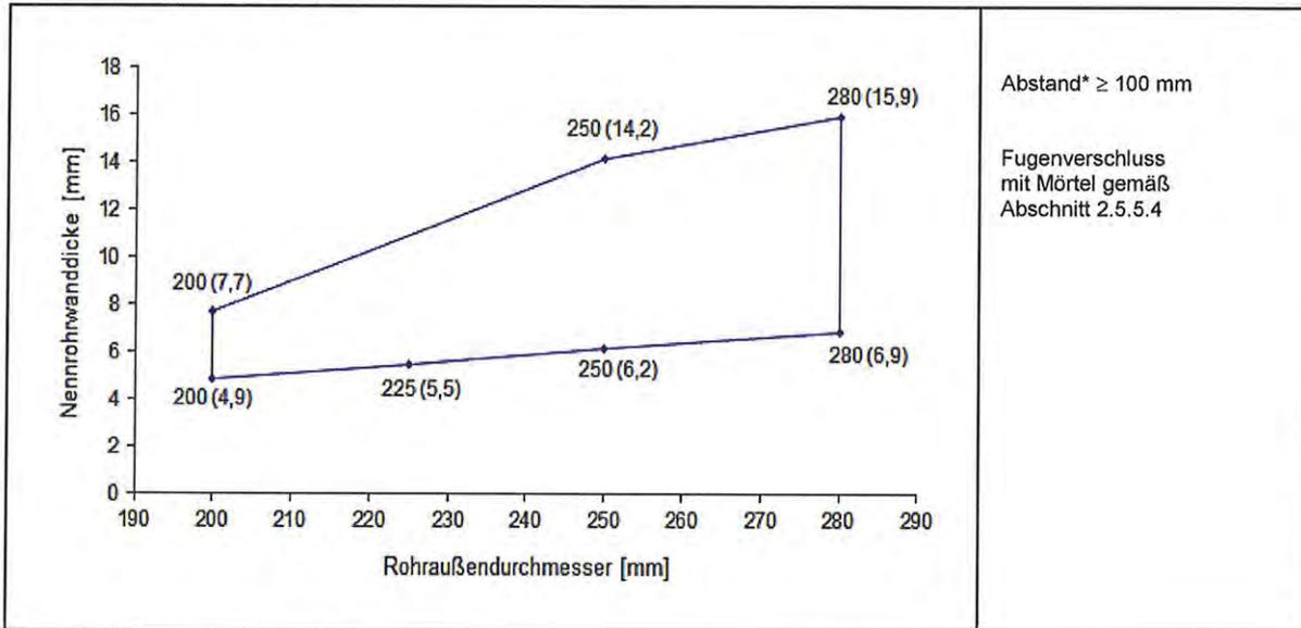
**Rohre gemäß Rohrgruppe B-5:** (Rohre mit FEF-Isolierung, senkrecht zur Bauteiloberfläche durchgeführte Rohre, aufgesetzte Manschetten)
