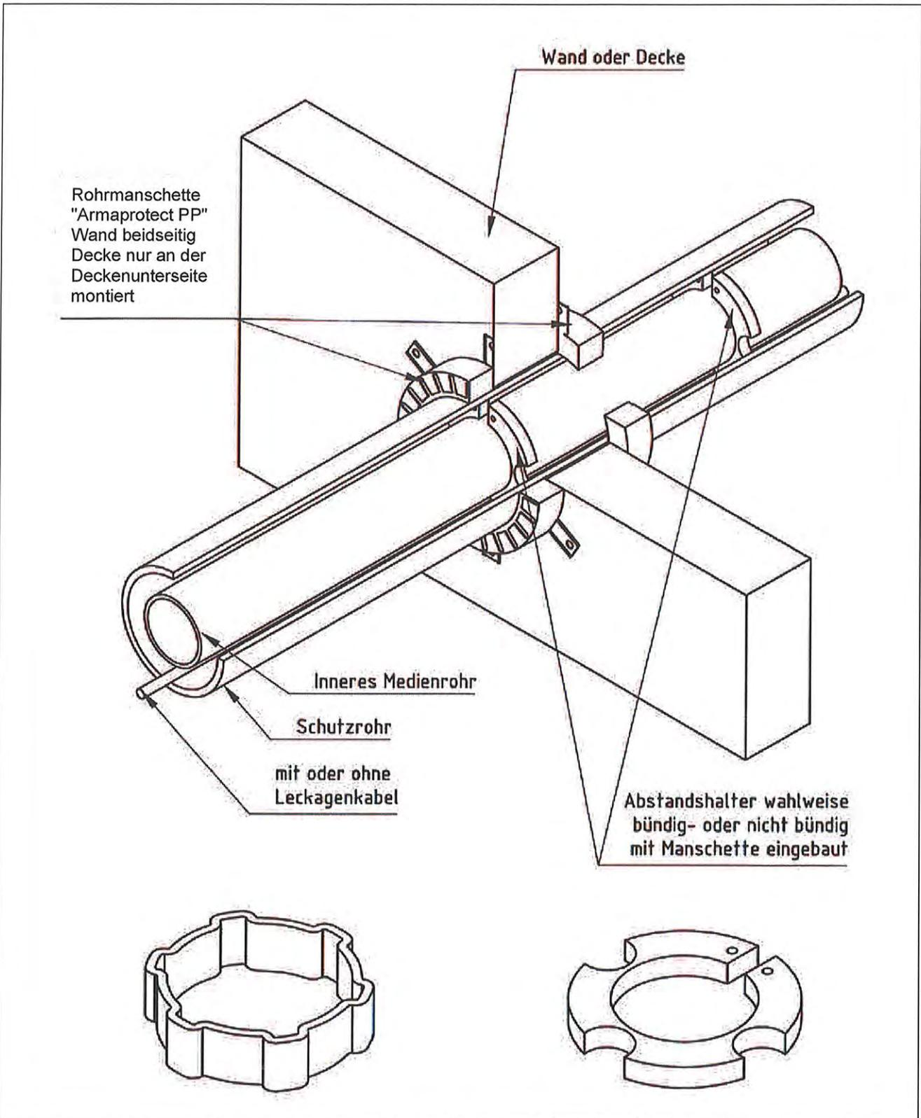
Feuerwiderstandsfähige Abschottung für Rohrleitungen aus Kunststoff "Armaprotect, Typ Armaprotect PP"
