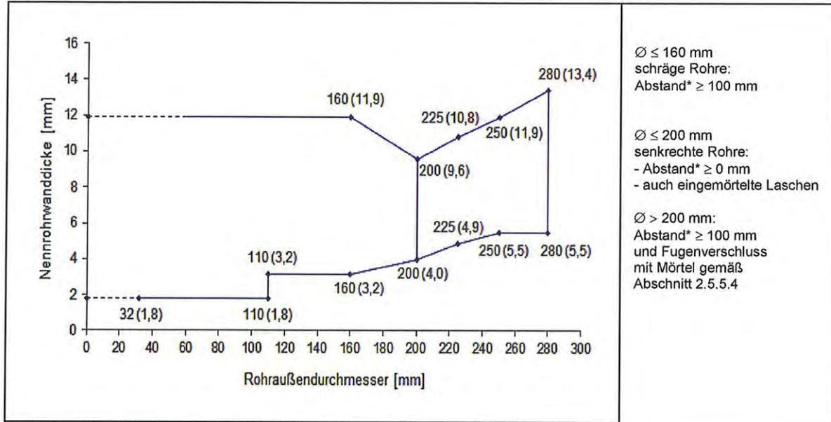
**Rohre gemäß Rohrgruppe A-8:** (Rohre mit FEF-Isolierung, senkrecht zur Bauteiloberfläche durchgeführte Rohre, aufgesetzte Manschetten)
