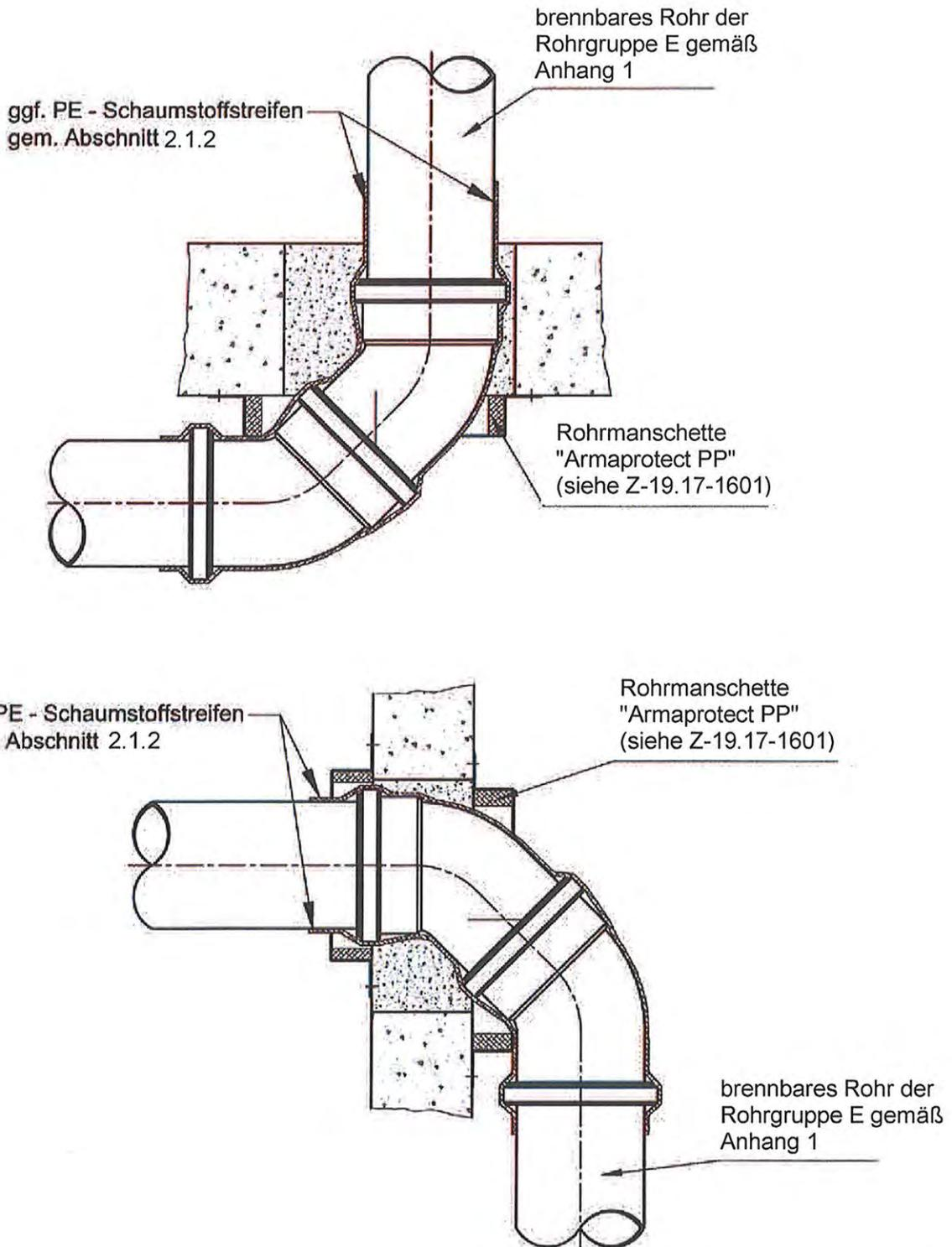
Feuerwiderstandsfähige Abschottung für Rohrleitungen aus Kunststoff "Armaprotect, Typ Armaprotect PP"
