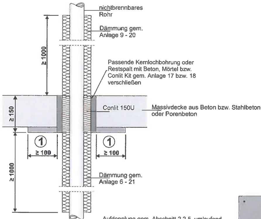
Aufdopplung gem. Abschnitt 2.2.5, umlaufend mind.  $b = 100$  mm breit, aus „Conlit Steelprotect Board“- bzw. aus nichtbrennbaren Bauplatten (Kalziumsilikat-Platten bzw. Gipsplatten Typ GKF nach DIN 18180 bzw. Typ DF nach DIN EN 520).
