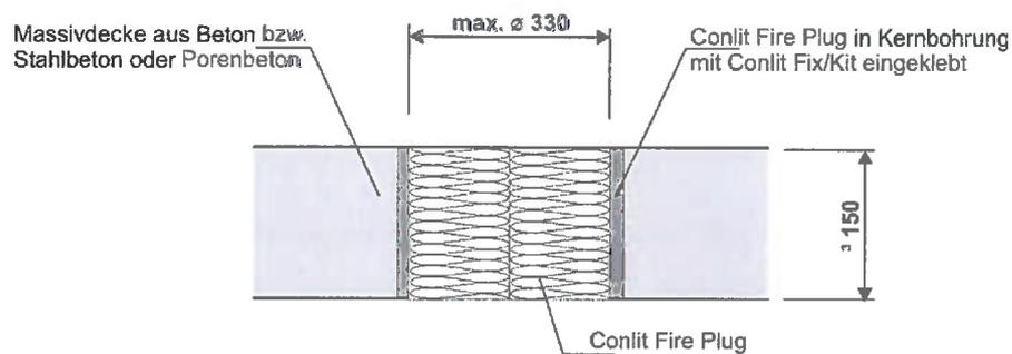
Die eingeklebten Conlit Fire Plug sind durch Sicherheitsmaßnahmen (z. B. Anordnung eines Trittschutzes) so zu sichern, dass der Conlit Fire Plug im Gebrauchszustand nicht heraus getreten werden kann.
