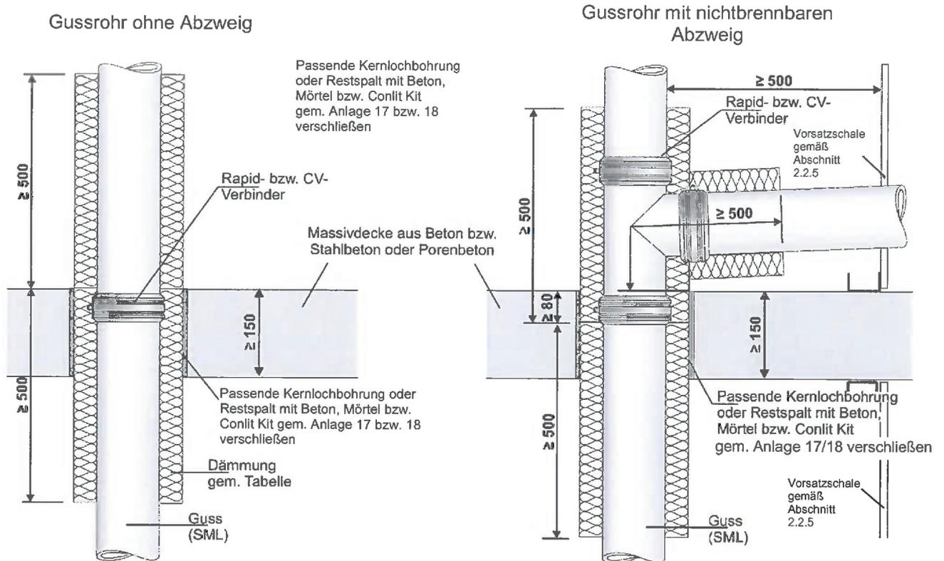
Die Rohrschalen müssen im Bereich der Rapid- bzw. CV-Verbinder angepasst werden.
