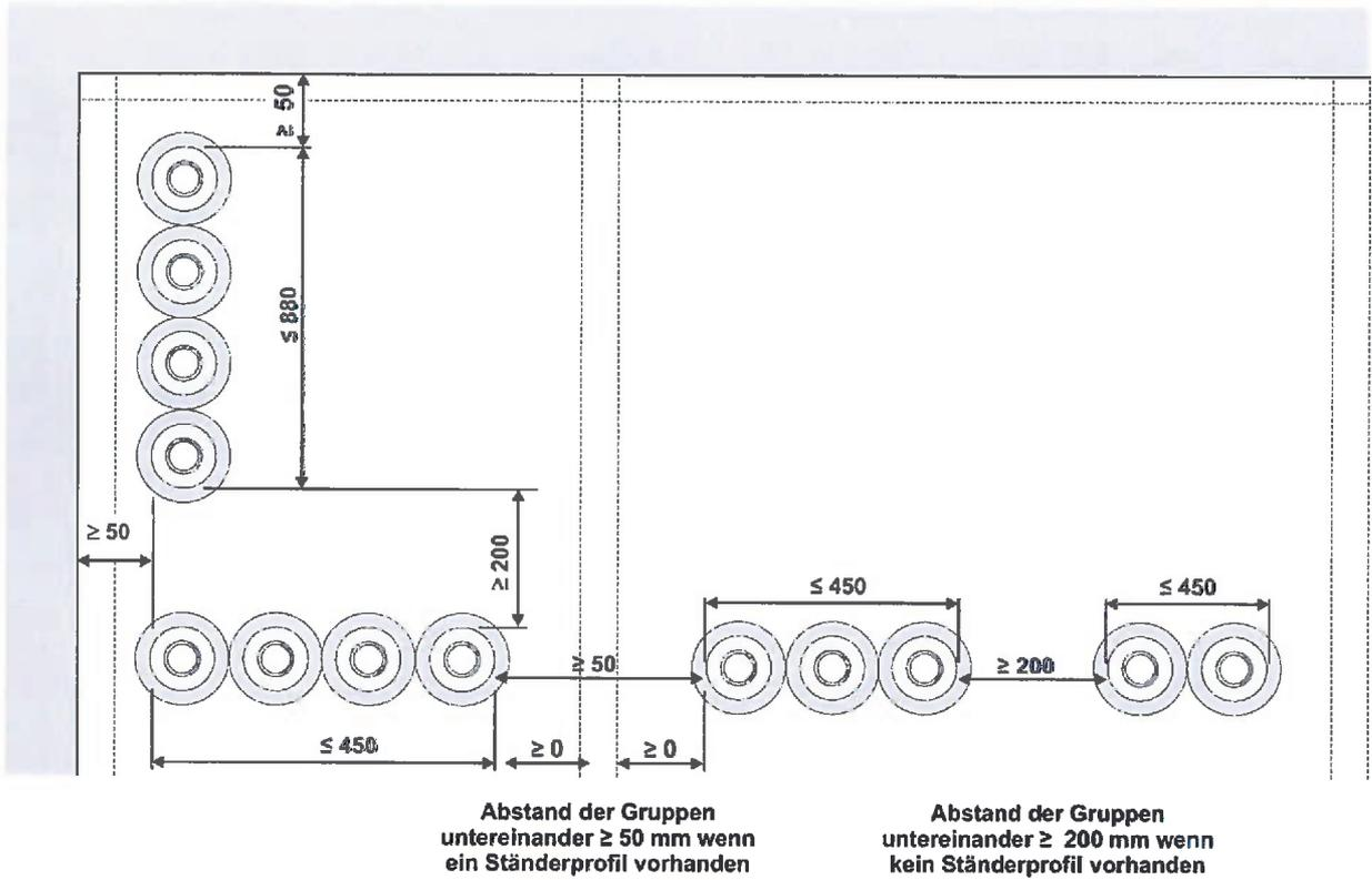
Alle Schalen bzw. Matten sind mit einem verzinkten Wickeldraht  $d \geq 0,6$  mm mit 6 Wicklungen / lfd. Meter am Rohr zu fixieren.
