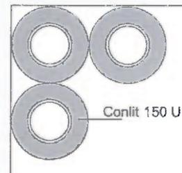
Alle Rohrabschottungen gemäß diesem abP dürfen im „Null- Abstand“ verlegt werden. Null- Abstand“ auch möglich zu Rohrabschottungen „Rockwool Rohrabschottung für brennbare Rohrleitungen“ gemäß abP Nr. P-3726(4140-MPA BS
