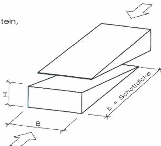
Der Nachinstallationskeil vereinfacht in schwierigen Einbaulagen das nachträgliche Öffnen der Kabelabschottung. Die mit den Nachinstallationskeilen belegte Schottfläche darf eine Größe (B x H) 300 mm x 150 mm nicht überschreiten.
