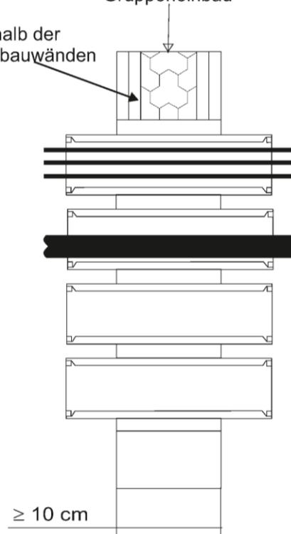
1: Gipsfugenfüller oder mineralischer Mörtel
