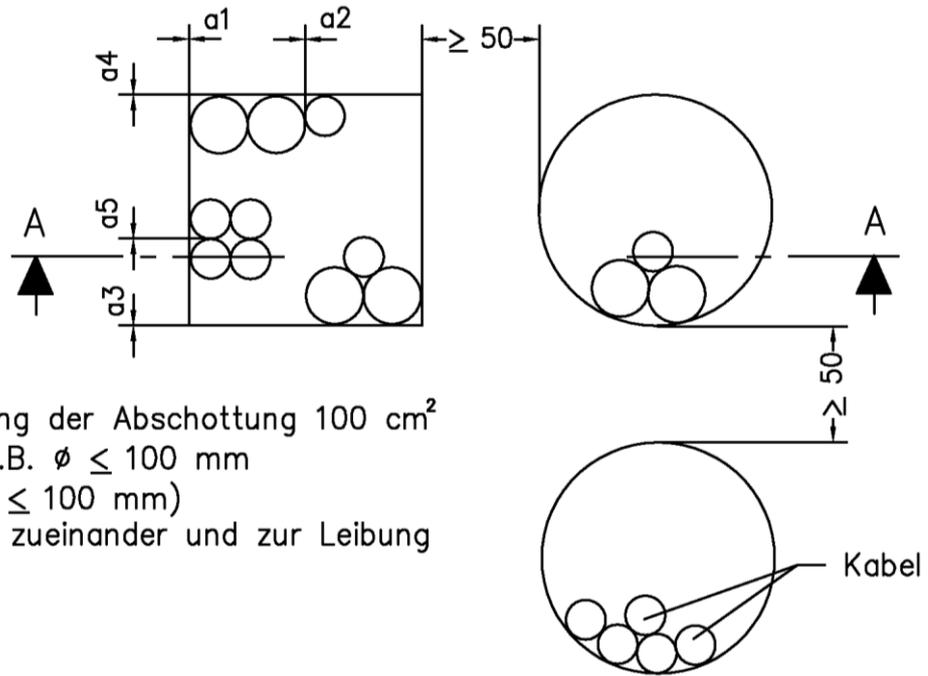
Maximale Abmessung der Abschottung 100 cm<sup>2</sup>
