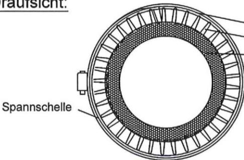
Manschetten für Rohraußendurchmesser  $d_a \leq 110$  mm:
