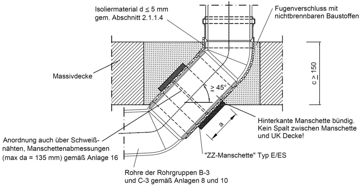
**"ZZ-Manschette" Typ E/ES, Feuerwiderstandsklasse R 120/R 90, bei Einbau in Massivdecke (Steckmuffe im Durchführungsbereich):**
