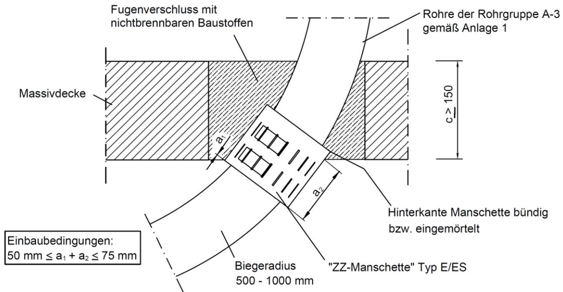
**"ZZ-Manschette" Typ E/ES, Feuerwiderstandsklasse R 90, bei Einbau in Massivwand (Rohrbögen):**
