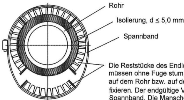
Rohr  $\leq$  DN 100: max. 3 Reststücke
